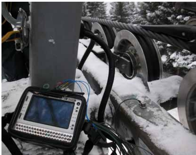
L'enregistrement de paramètres physiques sur les réducteurs de remontée-pente impose à la fois d'utiliser un appareil suffisamment léger pour être emporté par un opérateur à ski, et assez robuste pour supporter de très basses températures. C'est ce type d'application qui a poussé Dynae à développer son CTMO.
